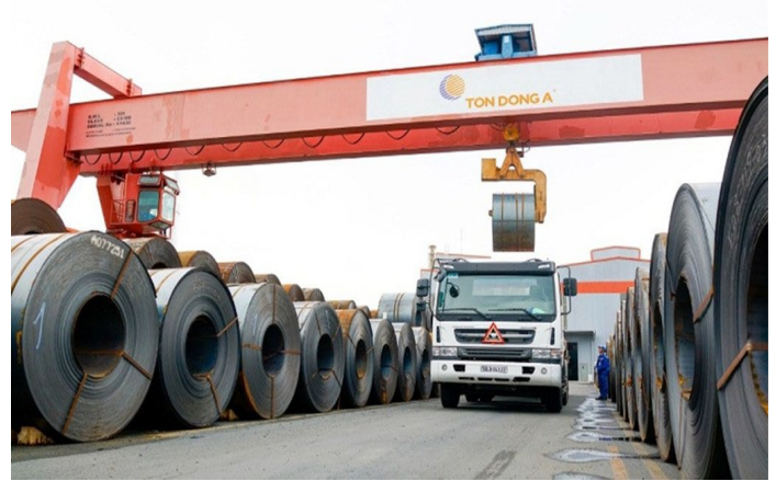
Hình 17: Thép cán nóng (HRC) trước khi được đưa vào dây chuyền tẩy rỉ (trong nhà máy tôn mạ)
